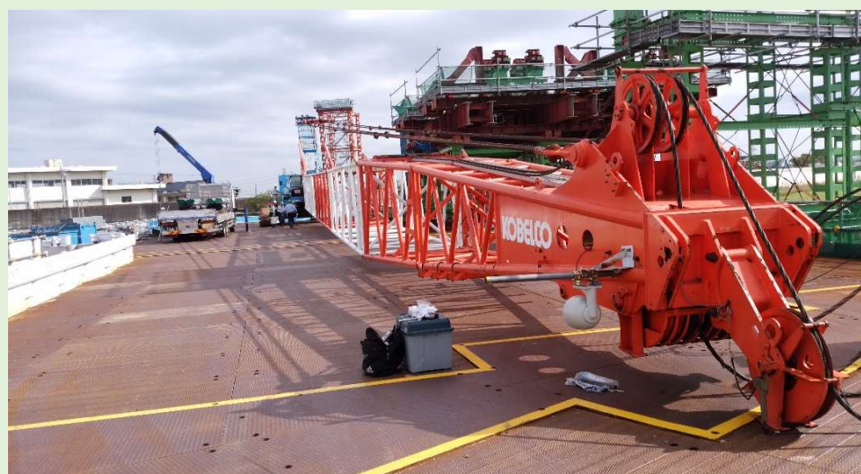
大型クレーン先端部に監視カメラ設置
